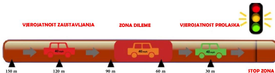
Slika 3. Prikaz zona odluke na prilazu semaforiziranom raskrižju
